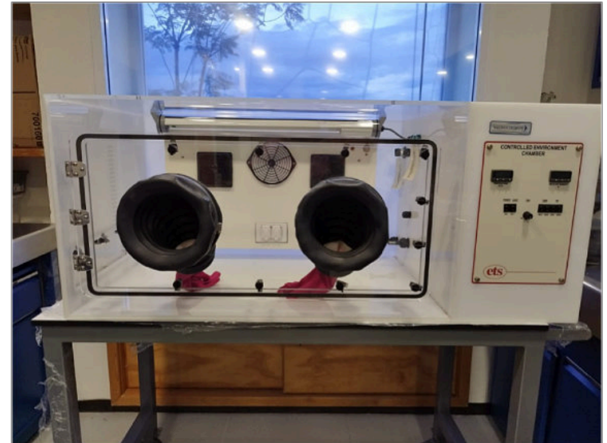
Figura 2. Caja de Guantes hermética en donde se hacen las mediciones de CN en el laboratorio de Geoquímica del Centro de Geociencias UNAM, Campus Juriquilla.
