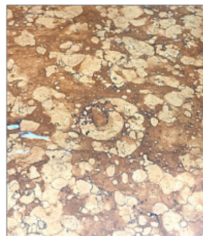
Fig. 11. Losa de mesada de local comercial en barrio de Palermo con amonites sobre caliza de la variedad Rosso Verona.
